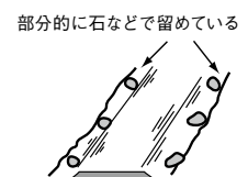
【土留めが部分的】
